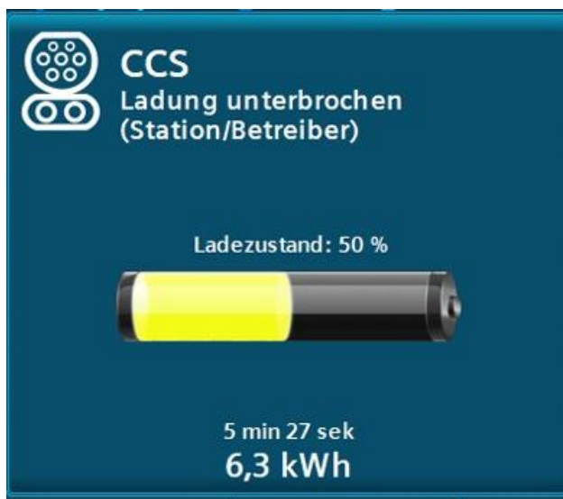
Bild 2-20 DC-Ladevorgang "Ladevorgang durch Ladestation / Betreiber unterbrochen"
