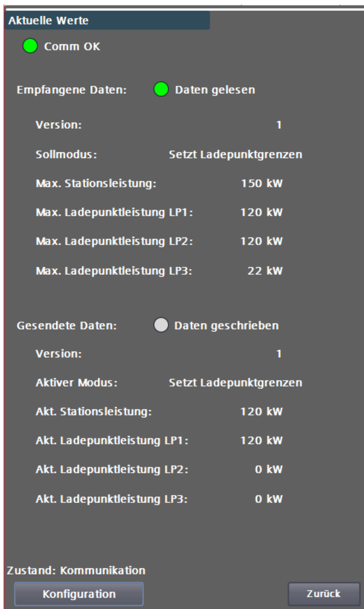
Bild 3-33 Beispiel für die Aktualdaten des externen Leistungsmanagements
