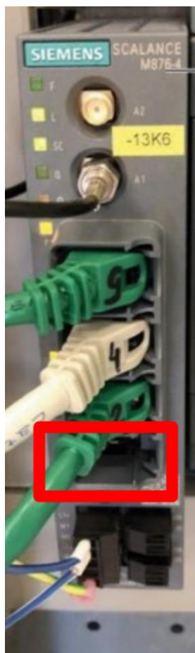
Bild 3-31 SCALANCE-Router mit markiertem Port für das ext. EMS
