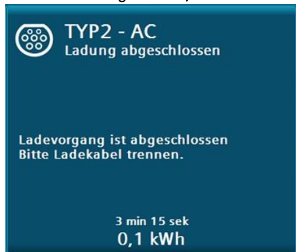
Bild 2-23 Ladevorgang beim AC-Laden beendet Aufforderung das Ladekabel zu abzustecken
