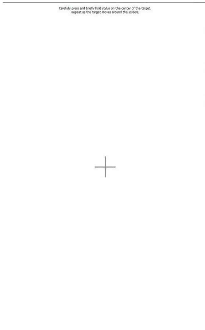
Bild 3-42 Kalibrierbild für den Touchscreen des HMI
