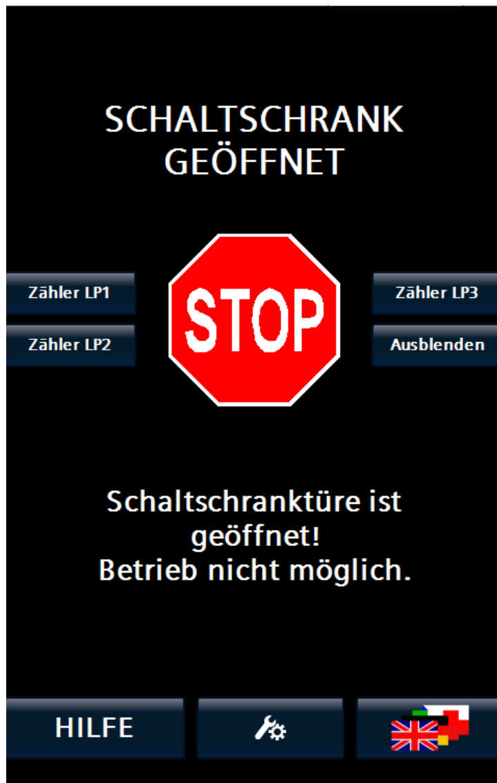
Bild 3-81 Schaltschranktür geöffnet bzw. nicht vollständig geschlossen
