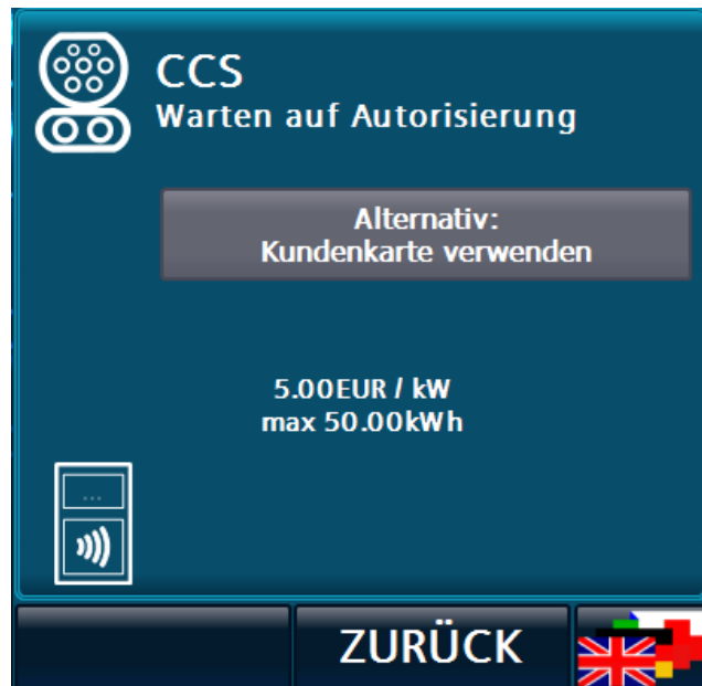
Bild 2-13 Ladevorgang starten – Anzeige der optionalen Alternativen 2
