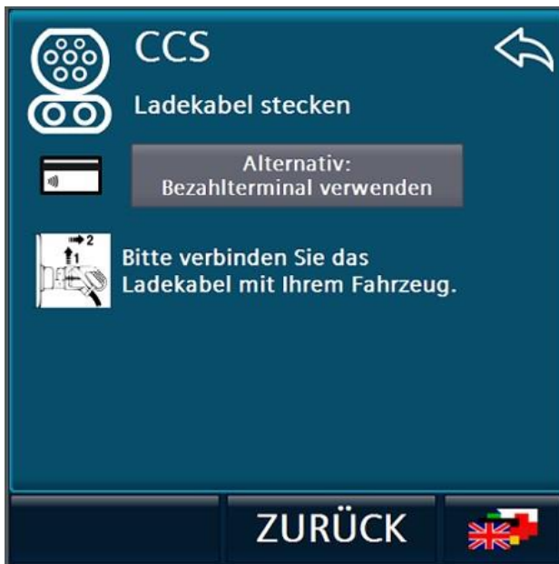
Bild 2-12 Ladevorgang starten – Anzeige der optionalen Alternativen 1
