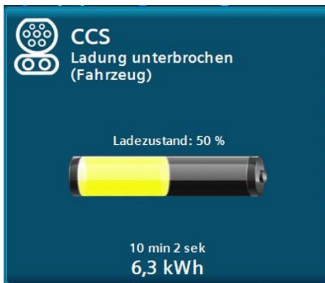
Bild 2-19 DC-Ladevorgang "Ladevorgang durch Fahrzeug unterbrochen"
