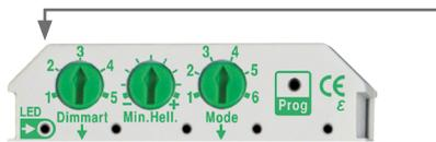
Die LED leuchtet im Einzustand rot (bei Ablauf der E/A-Rampe kurze Aussetzer, bei Ablauf des Schlummermodus Aussetzer alle 1s, bei ESL-Aufwärmphase Aussetzer alle 2s). Wird ein gültiges Funksignal empfangen, leuchtet sie (zusätzlich) grün. Wird Eingang 1 angesteuert, flackert die LED grün).
